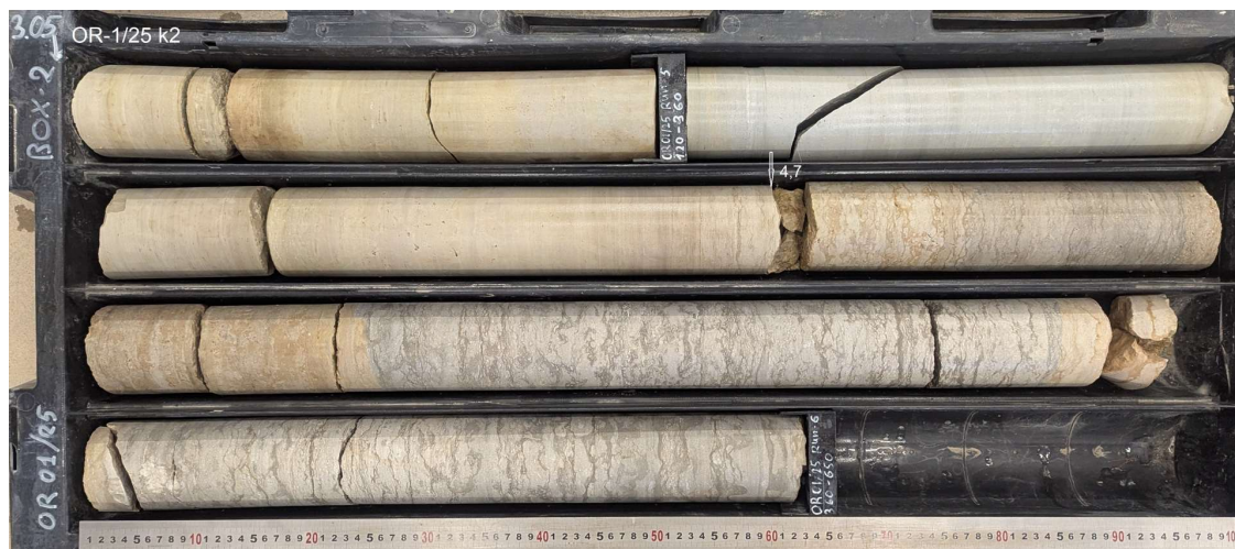
Foto 5.2. Ülemine massiivne dolokivi ja alumine lainjaskihiline dolomiidistunud lubjakivi puuraugus OR-1/25.
